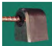
箱抜き治具の背面穴にDアンカー付き樹脂製ホルダーを挿入する。
